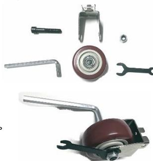
4. Собранные два роликовых кронштейна крепятся на пластиковые ножки, как показано на рисунке, а затем используйте шестигранную головку М5\*40 винты, контргайки М5, гаечный и шестигранный ключ для фиксации ролика в сборе на пластиковых ножках.
